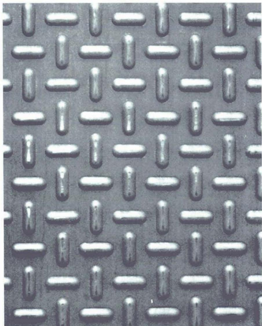
Le nostre LAMIERE BUGNATE vengono ottenute mediante punzonatura, eseguita su normali lamiere piane o su nastri. Lo spessore varia generalmente da un minimo di mm. 0,30 a un massimo di mm. 5. Il formato di serie è mm. 2000x1000 ma si possono eseguire moltissimi altri formati. Le lamiere bugnate trovano impiego per camminamenti, gradini, pavimentazioni, ecc. nell'industria e anche nell'arredamento.
